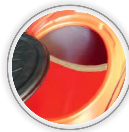
Waterproof bulkhead of luggage hold / wasserdichtes Schott in der Gepäck-Luke
